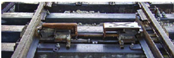
Verrou individuel de lame d'aiguille
